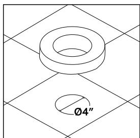
2. Pasang gasket ke lubang pembuangan.
