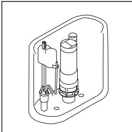
4. Pasang alat tangki (*tank fitting*) di dalam tangki.
