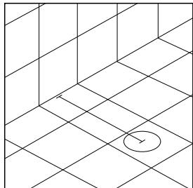
1. Siapkan lubang pembuangan sesuai dengan jarak As (*rough-in*) kloset. Kondisi lapangan sudah finishing dan instalasi air bersih telah tersedia.
