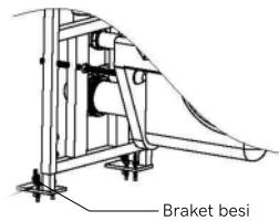
2. Pasang braket besi ke permukaan tanah.
