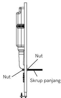
6. Sesuaikan panjang skrup pada besi penyangga dengan ketebalan dinding, setelah itu kencangkan skrup pada besi penyangga dengan menggunakan nut.
