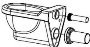
8. Pasang pipa lurus kecil dan pipa lurus besar pada masing-masing lubang yang sesuai pada toilet.
