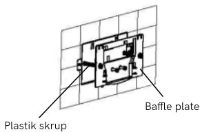
3. Masukkan baffle ke plastik skrup dan kencangkan dengan skrup.
