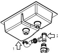
1. Masukkan dan kencangkan pipa penyambung ke bak cuci, diikuti dengan pipa siku.
