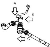
3. A. Masukkan dan kencangkan pipa overflow ke penyambung bentuk T dan sambungkan ke mangkok bak cuci lainnya.
