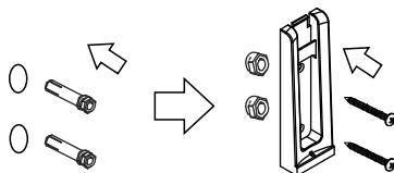
2. Pasang fisher pada lubang. Masukkan dan kencangkan body hanger dan skrup setelah memasang fisher.
