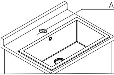
1. Pastikan bahwa diameter lubang berukuran 35 mm.
