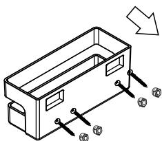
3. Posisikan body baki ke pemasangan fisher yang telah dilakukan sebelumnya. Pasang dan kenangkan skrup ke body baki.
