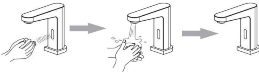
Catatan: Ketika tangan anda berada pada jarak deteksi sensor air akan mengalir keluar, tarik/jauhkan tangan anda dari jarak deteksi sensor dan air akan berhenti mengalir. Air akan berhenti secara otomatis setelah air keluar selama 60 detik terus menerus, jauhkan tangan anda dari jarak deteksi sensor selama 3 detik, lalu dekatkan tangan anda kembali ke jarak deteksi sensor agar air dapat keluar kembali.
