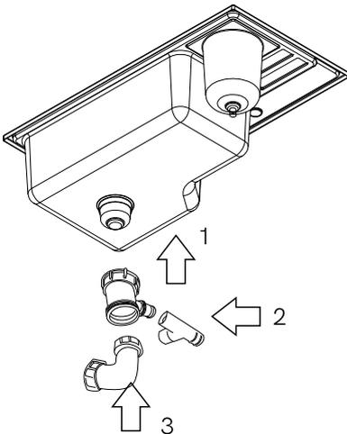
2. 1. Masukkan dan kencangkan pipa penyambung ke bak cuci.
