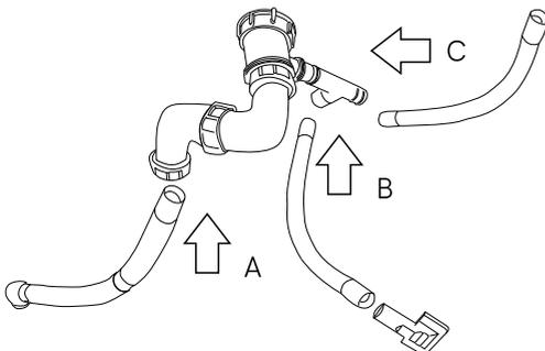
3. A. Masukkan dan kencangkan pipa pembuangan ke pipa siku.
