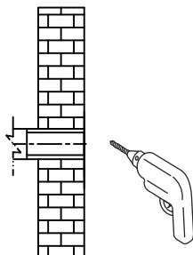
1. Lubangi dinding dan pastikan bahwa ukuran lubang cocok dengan ukuran fisher.
