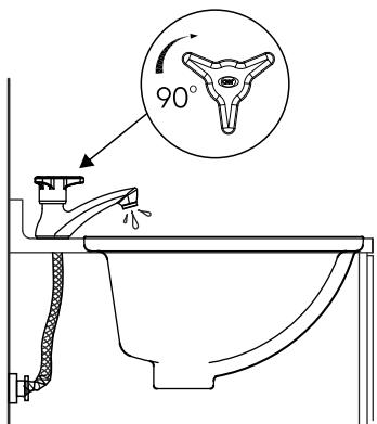
5. Putar pegangan kran  $90^\circ$  untuk menyalakan air dan putar kembali pegangan kran ke tempat semula untuk mematikan air.
