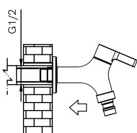
② Tempelkan plester pada insert dart agar menghindari terjadinya kebocoran
